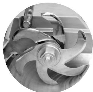
Tête avec 6 couteaux Head with 6 knives
